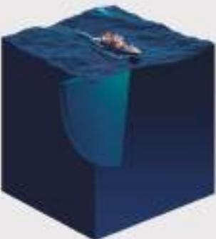
El SN90 tiene un corte vertical que puede apuntar a cualquier dirección dentro del propio abanico. Así se pueden controlar los límites del banco durante el lance.
